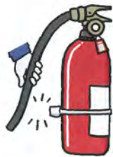
① ดึงสายฉีดออกจากถัง
